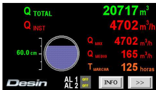
Pantalla principal con indicación del nivel en la tubería o el canal
